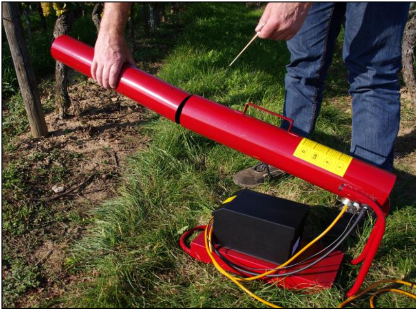
Schieben sie das Schallrohr in das Schußgestell ein und sichern es mit dem Feststellstift (130012). Siehe nächste Seite für Schallrohr-Einstellungen.
