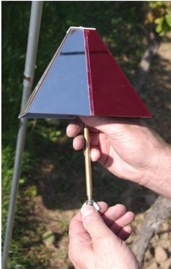
Nehmen Sie die Spiegelpyramide und entfernen sie die Flügelmutter, sowie die Zahnscheibe an der Unterseite.
