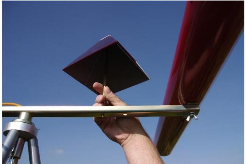
Nun wird die Spiegelpyramide auf der Traverse des Purivox Karussell Triplex V aufgesetzt. Achten sie darauf, dass die Spiegelpyramide auf der Seite des Schussrohres aufgesetzt wird
